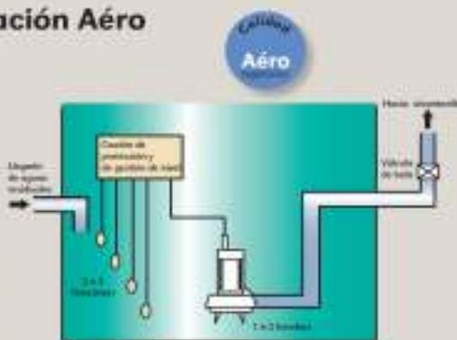
**Nuestra solución es el sistema AERO** que asegura tanto la función de gestión de niveles como la de protección de las bombas. Dispone de un microcontrolador encargado de almacenar y tratar los datos y una visualización en pantalla del estado de funcionamiento.
