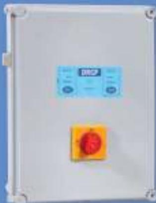
Este cuadro sirve para la gestión completa y la protección de la instalación gracias a un sensor de presión que mide el nivel a través de un tubo sumergido en la cuba. Por otra parte, un sistema permanente de inyección de aire en el tubo evita el atascamiento. El cuadro tiene también por función asegurar una protección completa de las bombas contra los sobre intensidades, subidas y bajadas de tensión y la falta de fase.
