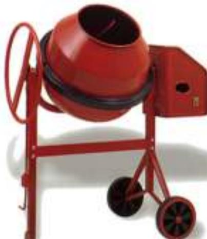
Bastidor de acero de alta resistencia, con patas desmontables. Cuba de chapa de acero embutido. Cabina de chapa estampada, muy accesible y que asegura optima protección al motor. Volante muy manejable y enclavamiento de volteo accionado por pedal. Diseñada para poder ser apilada con ahorro de espacio en transporte y almacenamiento. Equipada con motor eléctrico monofásico o de gasolina. Capacidad : 136 litros. CÓDIGO: 663H
