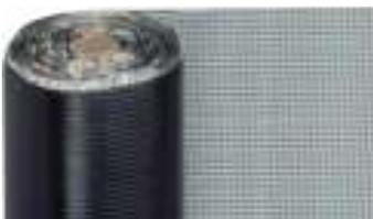
Son laminas asfáltica de superficie autoprottegida por una hoja de aluminio gofrado de 80 micras, de color natural, rojo o verde. Están compuestas por un mastico bituminoso oxiasfalto o betún modificado con elastómero SBS. El ancho de lamina es de 1 m. CÓDIGO: 6141LAM
