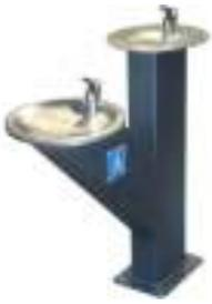
Cuerpo de hierro galvanizado y lacado. Griferías y salpicaderos en acero inoxidable. Altura total 1300 mm. Altura superior del grifo 850 mm. Altura del grifo inferior : 700 mm. Anclaje : mediante cuatro pernos M10. CÓDIGO : 3249F
