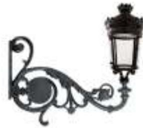
Repisa de fundición de aluminio dispone de una imprimación antioxidante acabado en color negro. Medidas: 690 mm x 375 mm. Acople con la luminaria mediante manguito de 3/4". Fijación a la columna mediante pletina con 2 tornillos. CÓDIGO : 334F
